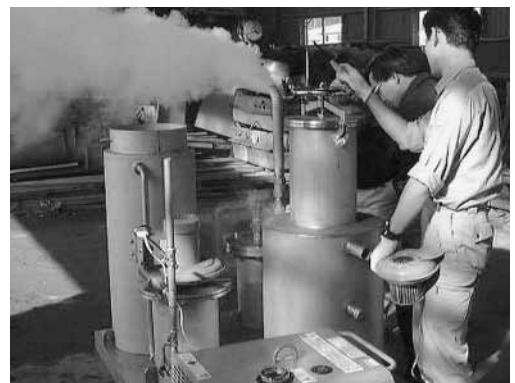
いぶした木材から発生するガスを利用した木ガス発電
