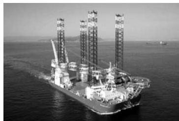
←作業台船「シラー」 丸紅株式会社ホームページより ・2015年竣工 ・全長139m×全幅50m×深さ11m
