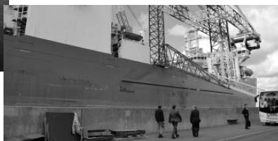
←作業台船「シラー」 丸紅株式会社ホームページより ・2015年竣工 ・全長139m×全幅50m×深さ11m
