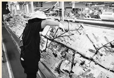
ワイヤーハーネスの組み立て作業。普通自動車用では4mの電線が350本ほど束ねられている。
