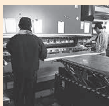
一つ一つの部品に合わせ金型を調整していく
