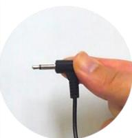
※コードの抜き差しは線を引っ張らず必ずジャック部分を持って行ってください。
